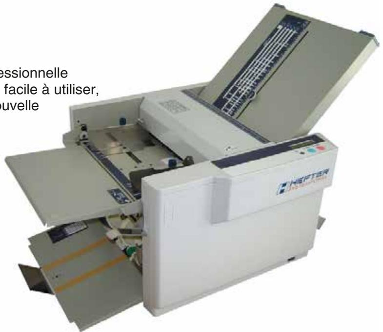
Grâce au réglage de la pression, la machine peut usiner différents grammages et types de papier.
